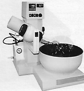
Il Rotavapor è impiegato nei laboratori chimici. A partire da questo strumento è stato creato il Rotaval, che distilla qualsiasi tipo di prodotto.
